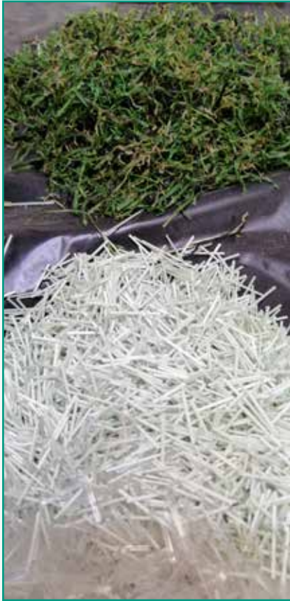
I nostri ricercatori all'opera nella realizzazione di conglomerati cementizi 'green' con aggregati e fibre plastiche da riciclo
