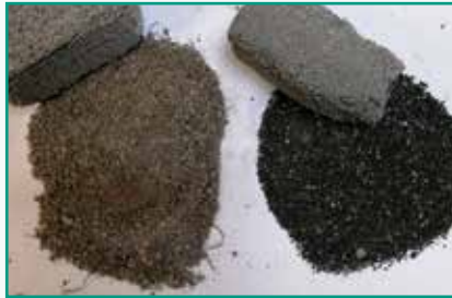
I nostri ricercatori all'opera nella realizzazione di conglomerati cementizi 'green' con aggregati e fibre plastiche da riciclo
