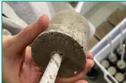
Produzione di campioni in calcestruzzo contenenti biochar o aggregati in plastica da riciclo, valutazione delle proprietà meccaniche e misure elettrochimiche
