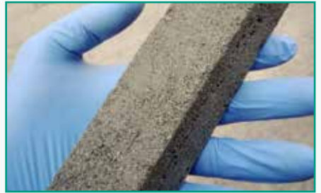
I nostri ricercatori all'opera nella realizzazione di conglomerati cementizi 'green' con aggregati e fibre plastiche da riciclo
