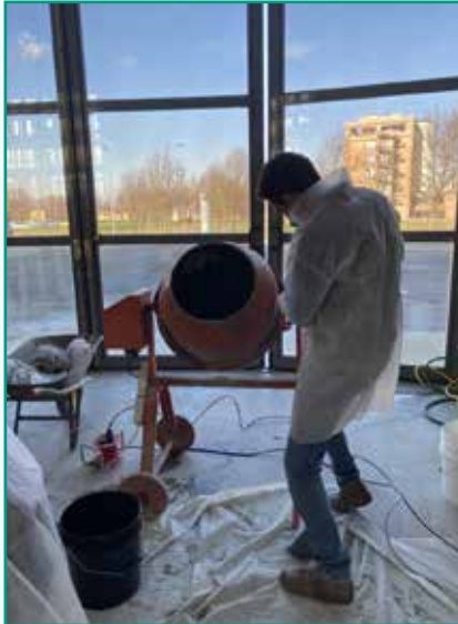
Produzione di campioni in calcestruzzo contenenti biochar o aggregati in plastica da riciclo, valutazione delle proprietà meccaniche e misure elettrochimiche
